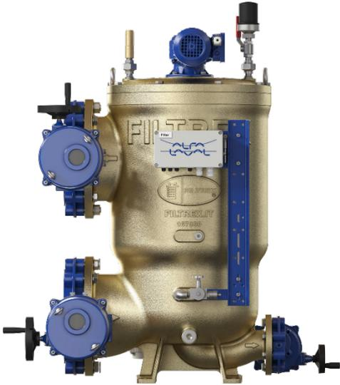
压载运行期间使用滤清器阻挡较大生物体的进入，减少压载水舱沉积物。卸压载期间采用旁路，使用少部分系统流量进行自动反冲洗，以清洁滤清器，不仅提高反冲洗效率，而且通过产生更高的净容量来提高整个滤清器的有效性。
