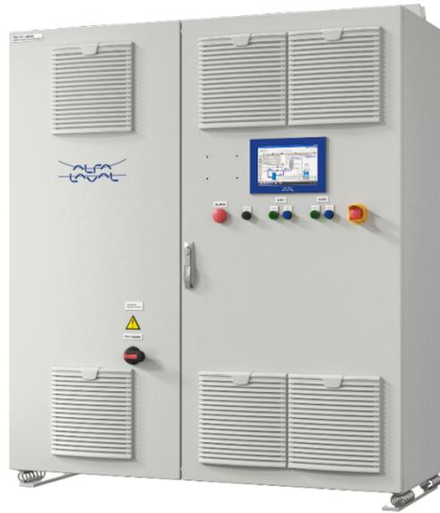
PureBallast 3 Ultra电气柜为紫外线灯供电，可置于距离紫外线反应器100m之处。配置10英寸图形触摸屏界面，使用简易、直观。轻触即可启动或停止操作。控制系统可通过Modbus与船上自动化系统集成，允许通过船舶的综合船舶控制系统访问所有功能。
