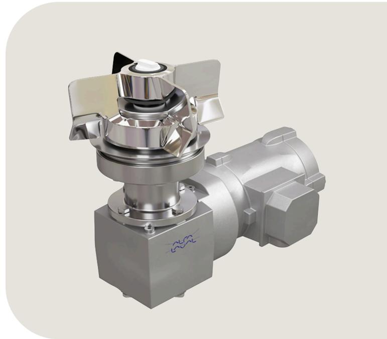
ルのマグネットカップリングのユニークな設計により、インペラの浮上が常に保証されます。これにより、ドライ運転が可能となり、タンクからのプロセス液の完全な排出が可能となりました。これにより、ドライ運転が可能となり、タンクからのプロセス液の完全な排出が可能となりました。また、CIP 液やスチームをミキサーのあらゆる部分に自由に流すことができるため、徹底的な洗浄が可能です。また、インペラの浮上により、軸方向の摩耗もなくなります。
