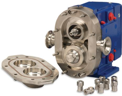
Alfa Laval лопасти роторов (поршни) вращаются по окружности канала в кожухе насоса. Это постоянно создает частичный вакуум во всасывающем отверстии, роторы расцепляются, заставляя жидкость поступать в насос. Жидкость перемещается по каналу лопастями ротора и вытесняется, когда лопасти ротора сходятся, образуя давление в выпускном отверстии. Направление потока можно менять.
