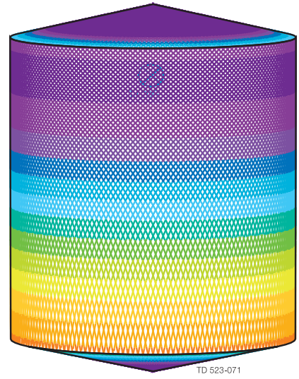
D4. 6m H5. 5m, Toftejorg TJ 20G, 4 x \phi 5. 5 mm, 时间 = 8. 3 分钟, 耗水量 = 1612 升
