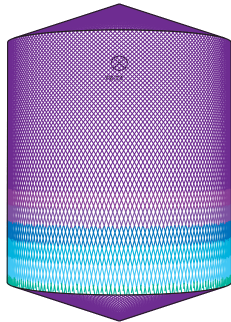
D5 m Alt. 6 m, Toftejorg TZ-74 Versión de limpieza automática, 4 x \varnothing 7 mm, 0 % Tiempo = 15.3 mín., Consumo de agua = 4853 l
