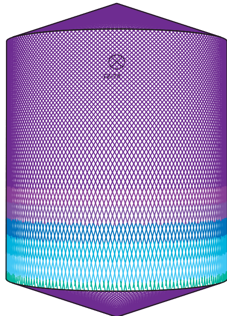
D5 m M6 m, Toftejorg TZ-74 öntisztító változat, 4 x ø7 mm, 0% Idő = 15.3 perc, Vízfogyasztás = 4853 l
