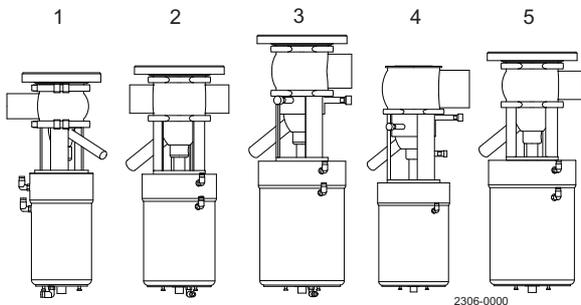
1. DN50 con brida de depósito, actuador grupo 3 incluyendo elevación de asiento y empuje de asiento
