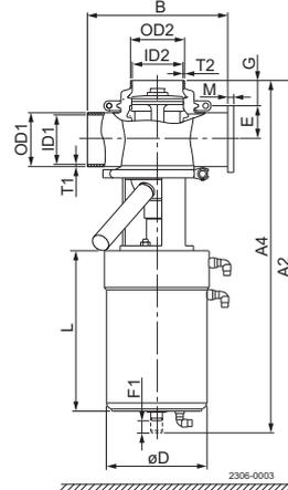
A1 + A2 = Espacio libre mínimo para permitir que el actuador y las partes de la válvula interna se puedan levantar del cuerpo de la válvula. Si ha instalado ThinkTop, añada 180 mm.
