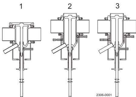
1. CIP externo de la cámara de fugas
