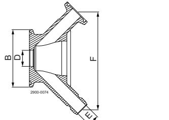
Корпус клапана: Приварка к резервуару
